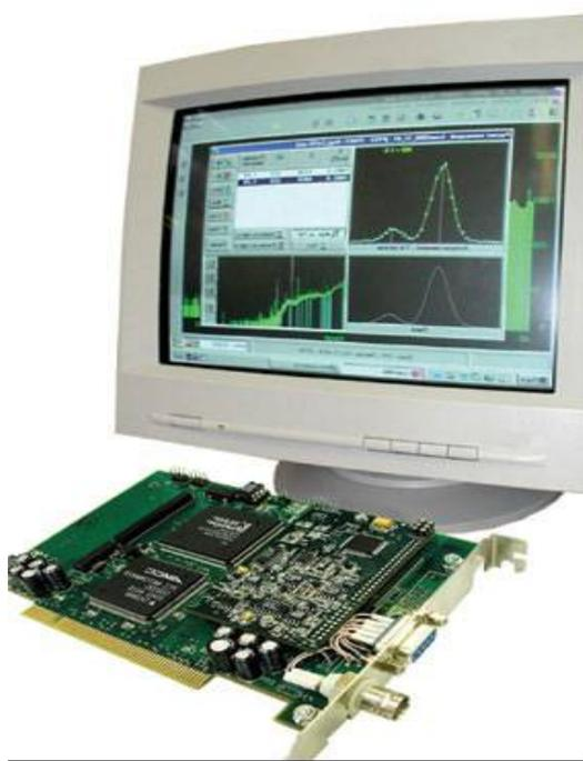
Рисунок 7.2.2 - Спектрометрический одноплатный АЦП
