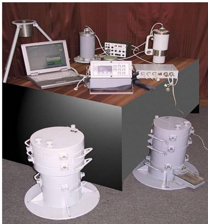
Рис.7.6.1 - Полевой гамма-спектрометр ПГС
