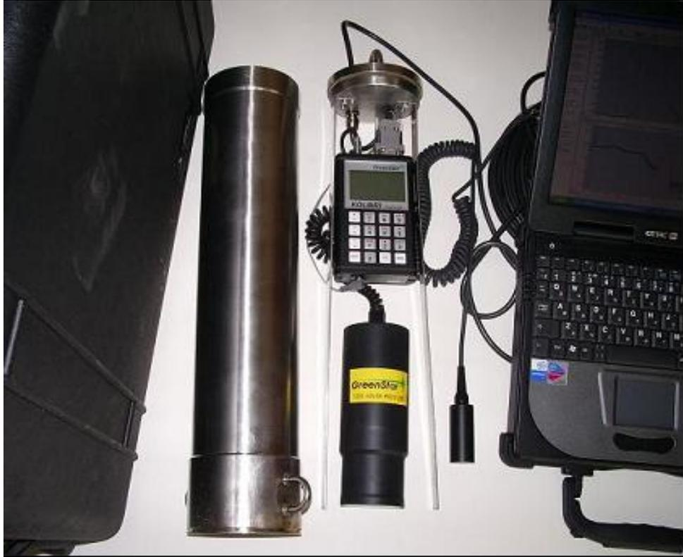
Рис. 7.7.6 - Спектрометрический комплекс «Нырок-1»
