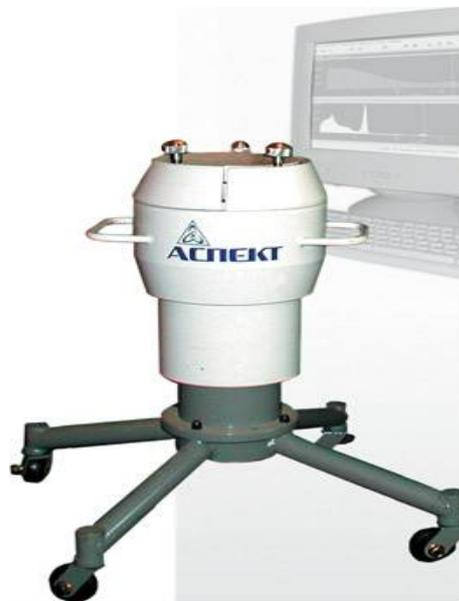
Рис. 7.2.1 - Сцинтилляционный спектрометр ГАММА-1С
