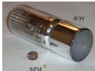
Рис 4.1 - Фотография вакуумного ФЭУ и SiPM.
