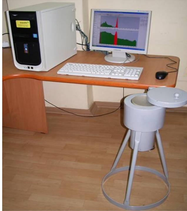
Рис. 7.7.2 - Комплекс спектрометрический с СКС-07П\_Г37 по СКС-07П\_Г48
