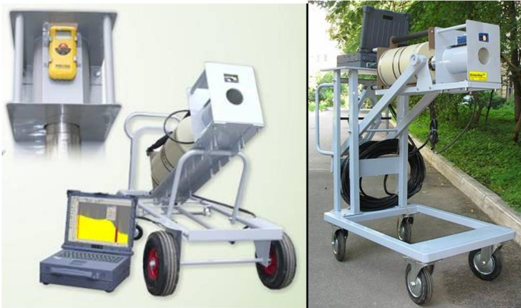
Рис. 7.7.3 - Мобильный спектрометрический паспортизатор
