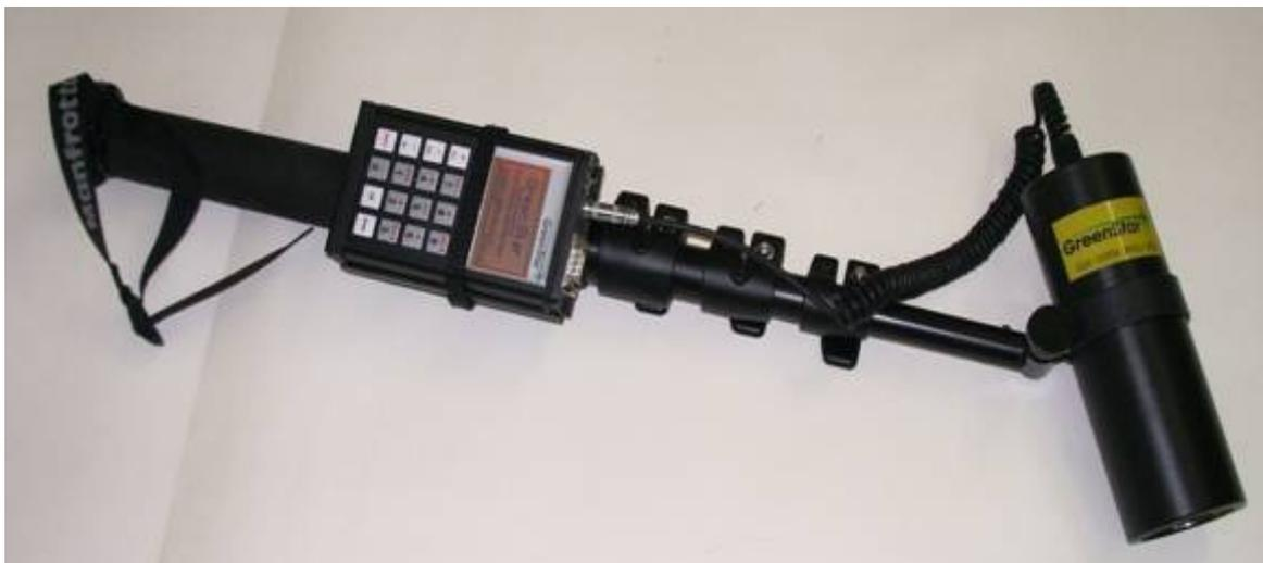
Рис. 7.7.10 - Процессор импульсных сигналов «Колибри»
