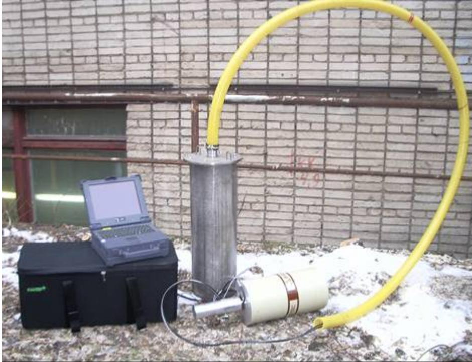
Рис. 7.7.5 - Мобильный спектрометрический комплекс «Нырок-2»
