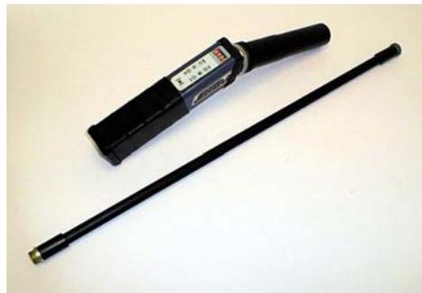
Рис. 8.5.2 - Радиационные мониторы серии ГНОМ
