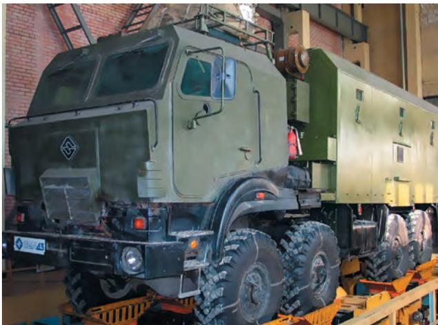
Спецмашина-модуль на испытательном стенде
